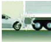
Va chạm tại vị trí mà lực va chạm hướng xuống dưới như va chạm vào phía dưới thùng sau xe tải Collisions where the force of the collision is downward such as an impact with the loading platform of a truck
